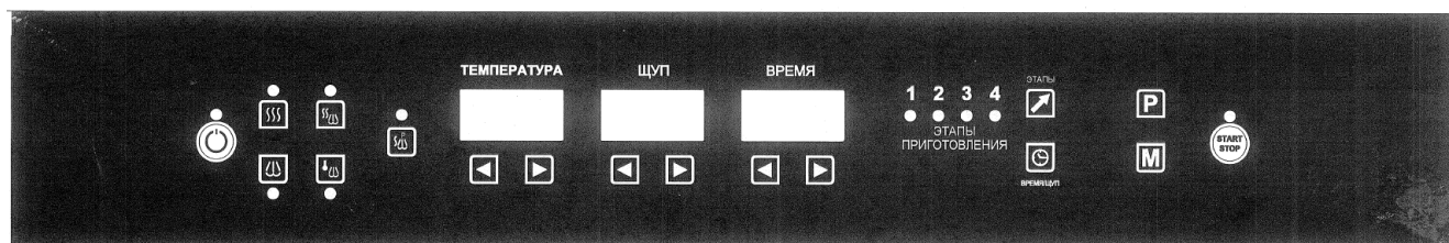
Рис. 3.2 Внешний вид панели управления ПКА6-1/3П
